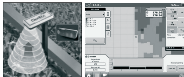
Slika 8. Prikaz fotoosjetljivoga senzora (lijevo) i prikaz trenutnoga stanja snimanog usjeva (desno) (izvor: Savjetodavna služba, 2012. )
