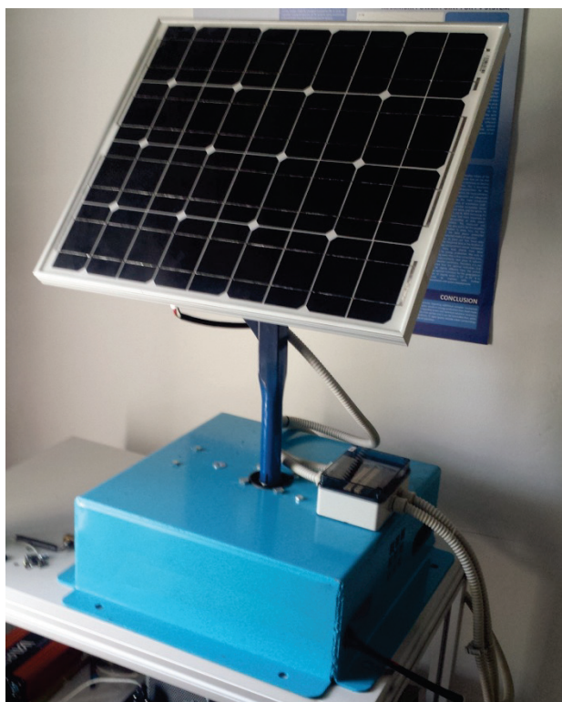
Slika 1. Prototipna mjerna stanica fotonaponskog sustava sa dvoosnim usmjerivačem
