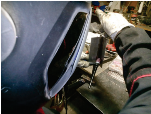
Slika 4. Prikaz vertikalnog zavarivanja T - spoja prema gore
