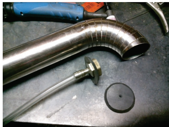
Slika 16. Naprava kućne izrade za zaštitu korijenskog zvara kod zavarivanja cijevi
