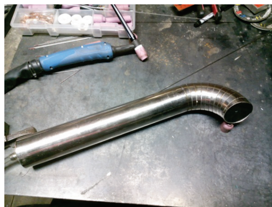
Slika 17. Prikaz pripremljene cijevi za početak zavarivanja s napravom za zaštitu korijenskog zvara
