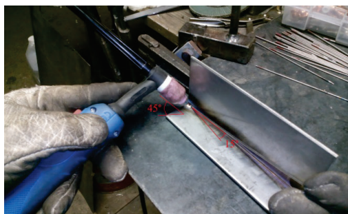
Slika 15. Položaj gorionika i materijala za dodavanje u odnosu na radni komad
