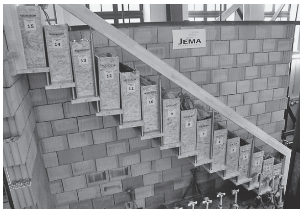
Figure 7 Prototypes of the staircase in version A during static load test - staircase loaded with uniform serviceability load ( V = 3.0 \text{ kN/m}^2 ) increased by the 0.3 multiple Slika 7. Prototip stubišta verzije A tijekom testa statičkog opterećenja – stubište je opterećeno ravnomjernim opterećenjem V = 3,0 \text{ kN/m}^2 uvećanim za 0,3 puta
