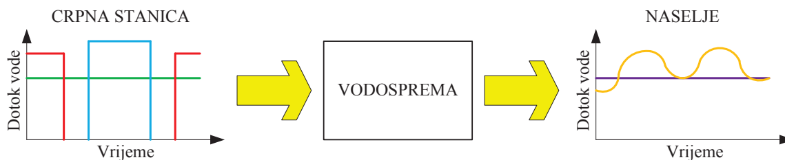
Slika 1. Shematski prikaz režima ulaza i izlaza vode iz vodospreme
