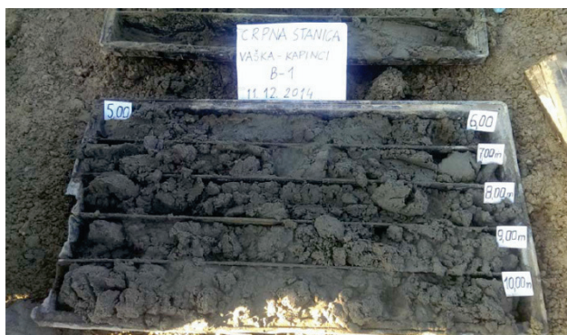
Slika 5. Sondažna jezgra, 1. bušotina, dubina 5-10 m
