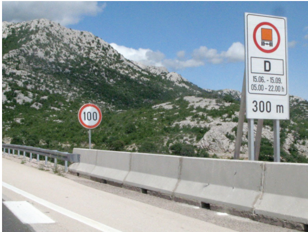
Slika 11 – Prometni znak za ograničavanje prijevoza kroz tunel na autocesti A1 (izvor: autorica)
