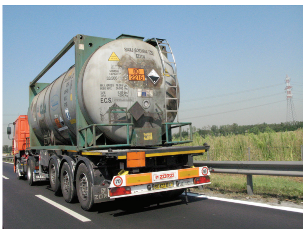
Slika 10 – Prijevoz Anhidrida maleinske kiseline, talina u cisterni. UN 2215, klasa 8. Vozilo je označeno narančastom pločom s brojevima i listicom br. 8 (korozivne tvari) (izvor: autorica).
