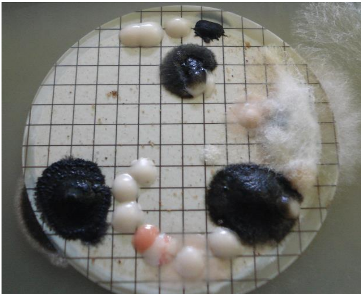
Slika 2: Mješovita mikrobna kultura izolirana na podlozi MEA s dna laboratorijskog spremnika s B100 nakon 2 mjeseca skladištenja
