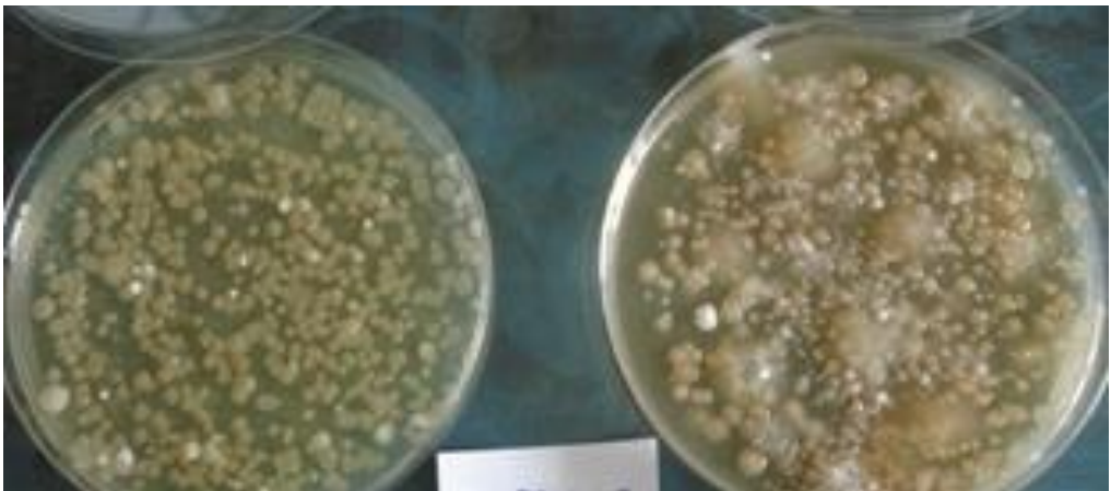
Slika 4: Mješovita mikrobnna kultura izolirana na dvije različite hranjive podloge (TSA, MEA) iz vodenog sloja s dna laboratorijskog spremnika sa dizelskim gorivom nakon tri mjeseca skladištenja
