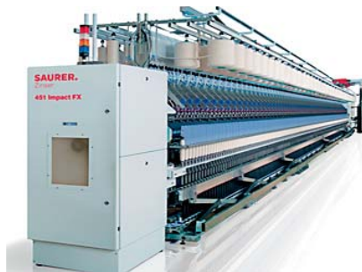
Sl.3 Zinser Impact 72 - prstenasta predilica za kompresijsko pređenje
