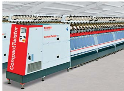
Sl.4 CompactTwister stroj za uvijanje s tehnologijom E 3
