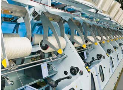
Sl.5 CableCorder CC4 stroj za kabliranje
