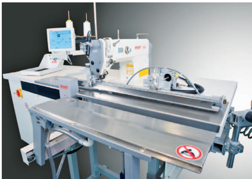
Sl.1 PFAFF 3586-14/02 automat za izradu ušitaka dužine do 490 x 20 mm
