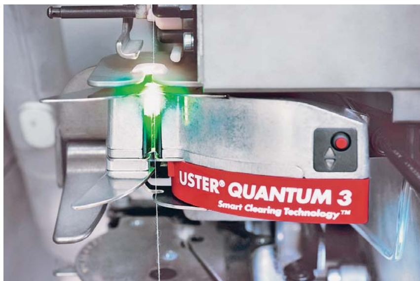
Sl.3 USTER® QUANTUM 3 - detekcija i eliminacija nečistoća u pređi
