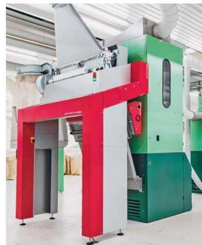
Sl.2 USTER® JOSSI VISION SHIELD - detekcija i eliminacija nečistoća u pamuku
