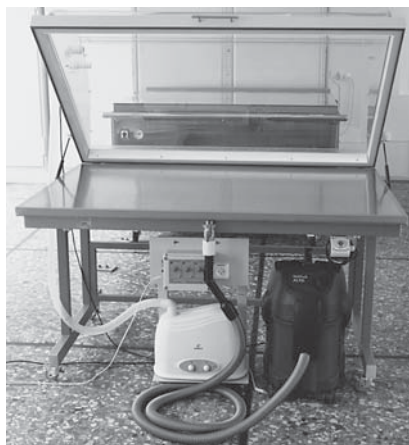
Sl.7 Niskotlačni stol BT1510 za restauraciju s pomičnom kupolom
