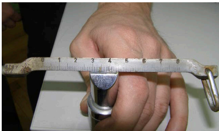
Slika 5. Skala duljine 8 cm s milimetarskom podjelom na reperu prilikom očitavanja.
