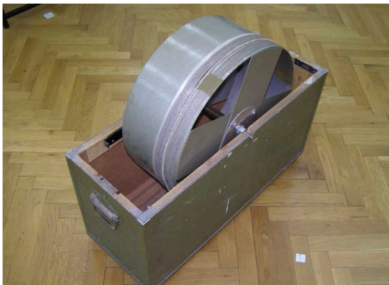
Slika 4. Metalni bubanj u drvenoj kutiji za čuvanje i transport invarnih žica.
