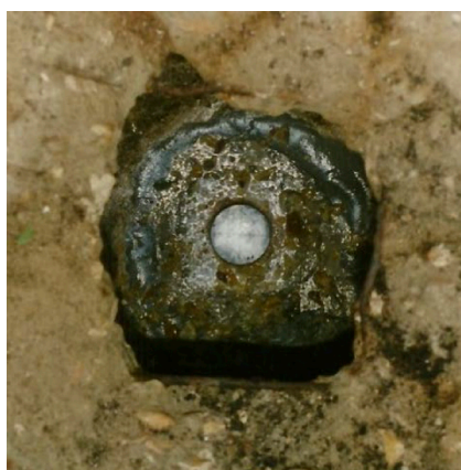
Slika 3. Podzemna stabilizacija istočne točke bazisa (Černe 2014).
