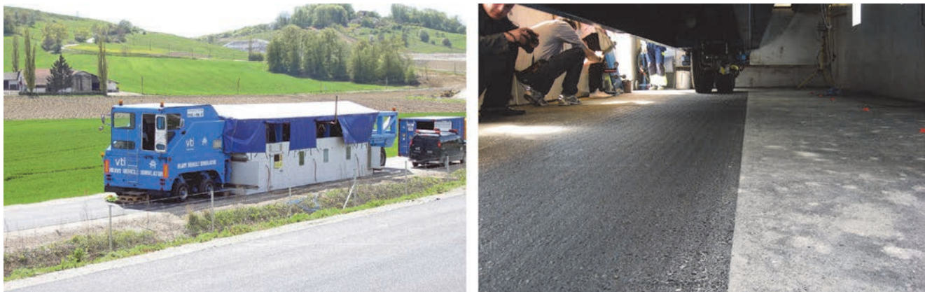
Slika 5. Simulator prolazaka teških vozila (HVS-Nordic)
