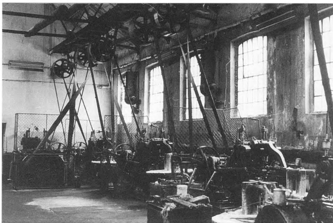
Ljepota industrijskog gesamtwerksa: odjel za šiljenje potkivačkih čavala sadrži originalno patentirane strojeve iz prvog desetljeća 20. stoljeća i prvorazredni je spomenik tehnikalija - još i danas koristi jedinstvenu obrtnu silu prijenosnih kola i remenica.
