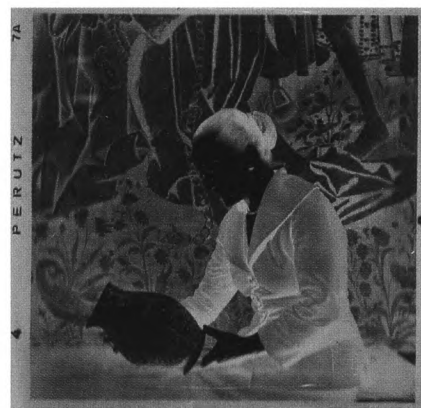
Česti primjer propadanja cb negativa je redukcija metalnog srebra u srebrni sulfid što je najčešće posljedica čuvanja u uvjetima povišene temperature i vlage, a u vrećicama i kutijama od lošeg papira. Oštećenje se na emulzionoj strani negativa vidi kao srebrni refleksi i to na onim područjima do kojih je dopirao utjecaj okolne atmosfere. © Arhiv Toše Dobca
