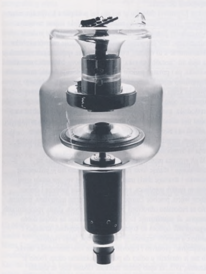
Rentgenska cijev s rotirajućom anodom "optilix", (darovatelj: Fer, Zagreb)
