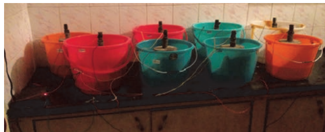
Slika 2. Test ubrzane korozije – eksperimentalni postav
