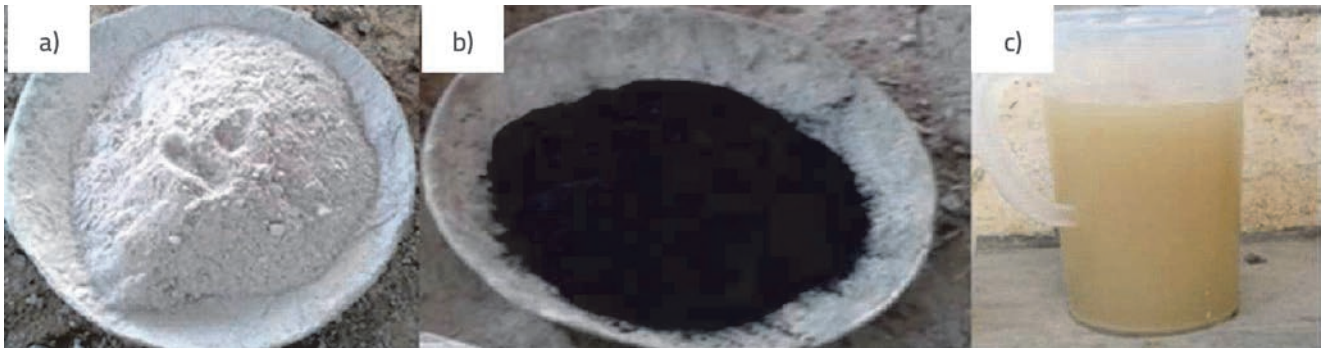
Slika 1. Materijali za geopolimerni beton: a) granulirana zgura, b) crni pepeo rižinih ljuski, c) mješavina natrijevog hidroksida i natrijevog silikata
