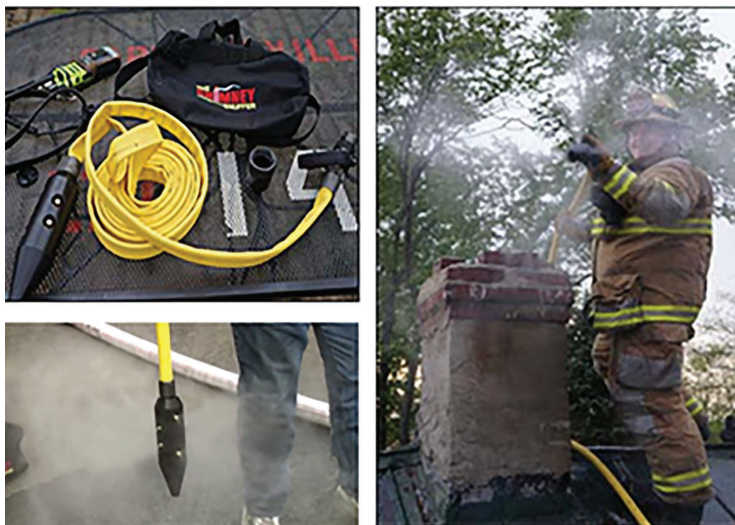
Slika 8: Snuffer set za gašenje požara dimnjaka
