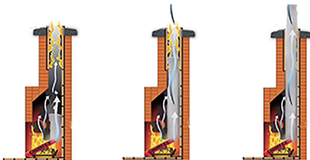
Slika 7: Prikaz načina gašenje požara Chimfex sredstvom
