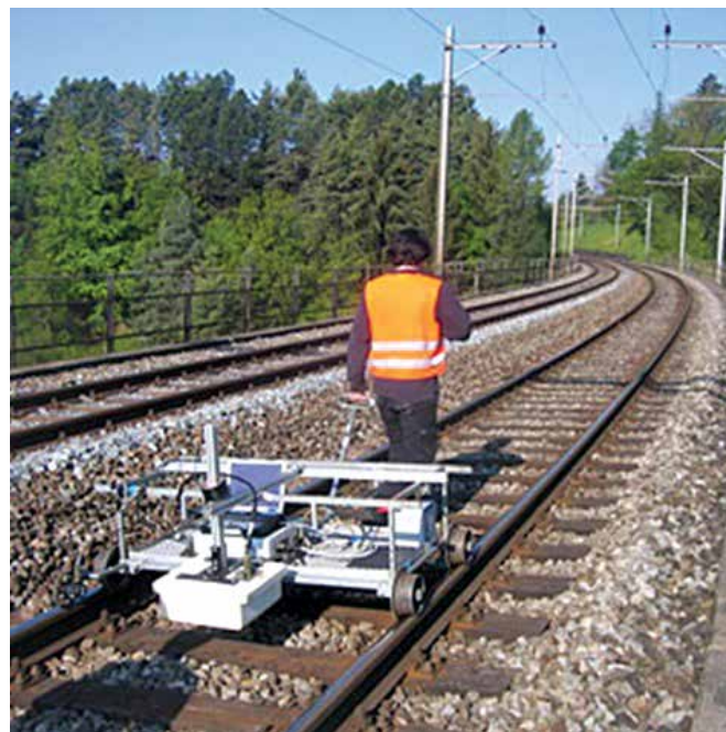
Slika 5. Višekanalni georadarski sustav instaliran na posebna kolica [19]
