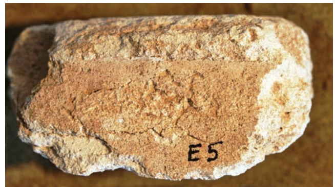
Sl. 7 Profilirani ukrasni vijenac štukature (fotografija: D. Bulić) Fig. 7 Decorative stucco cornice molding (photography: D. Bulić)
