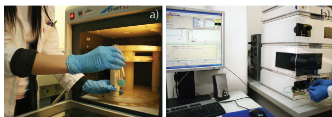
Slika 3 – a) Mikrovalni reaktor (Milestone start S); b) sustav tekućinski kromatograf-spektrometar masa HPLC/MS/MS (Agilent Technologies 6410 Triple Quad LC/MS)
