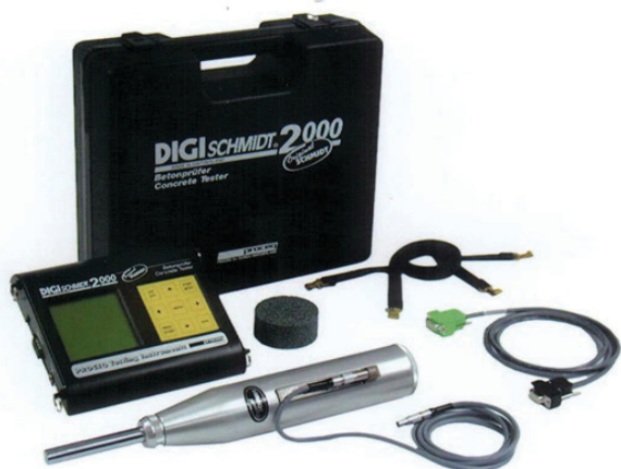
Slika 4. Digitalni sklerometar tipa Digi Schmidt (broj ND -1-2983-1234) proizvođača Proceq iz Švicarske
