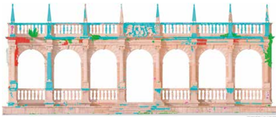
5 Konzervatorsko-restauratorska dokumentacija – mapiranje vrsta oštećenja (izradila: LAIRA s.r.l. 2012.)
