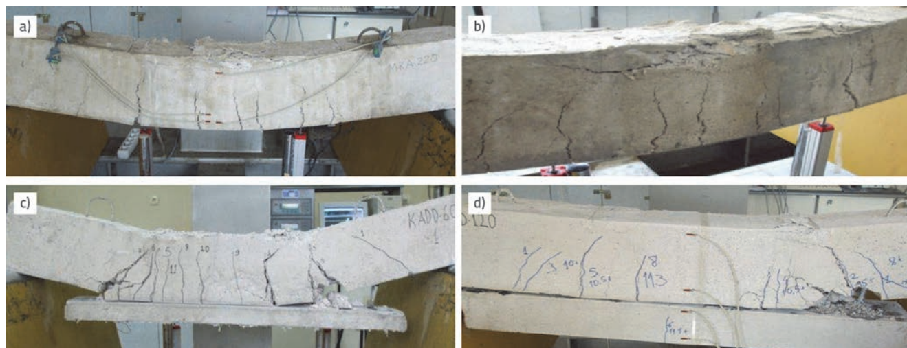
Slika 7. Izgled pukotina greda: a) REFA-1; b) REFA-2; c) KASPR60; d) KASPR120
