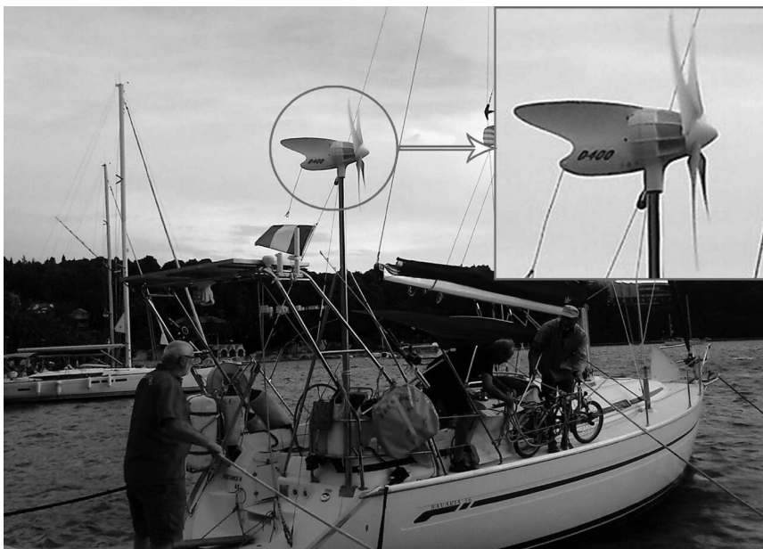
Slika 1. Mali generator D400 postavljen na jedrilicu
