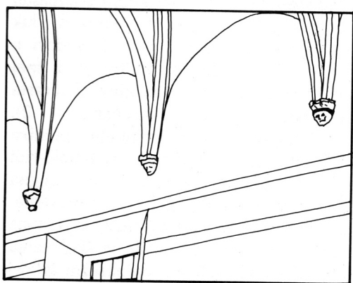
2. Krašić, svetišće stare župne crkve sv. Trojstva, spoj svoda i zida
