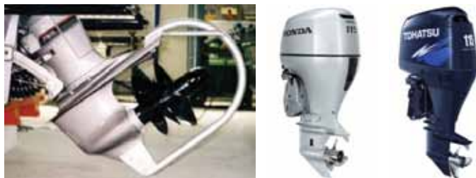
Slika 12. Pogonski motori i zaštita od udara elise Figure 12. The drive motors and shock protection propeller
