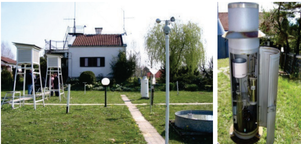
Slika 2. Meteorološka postaja Daruvar - ombrograf (Kuharić 2014)
