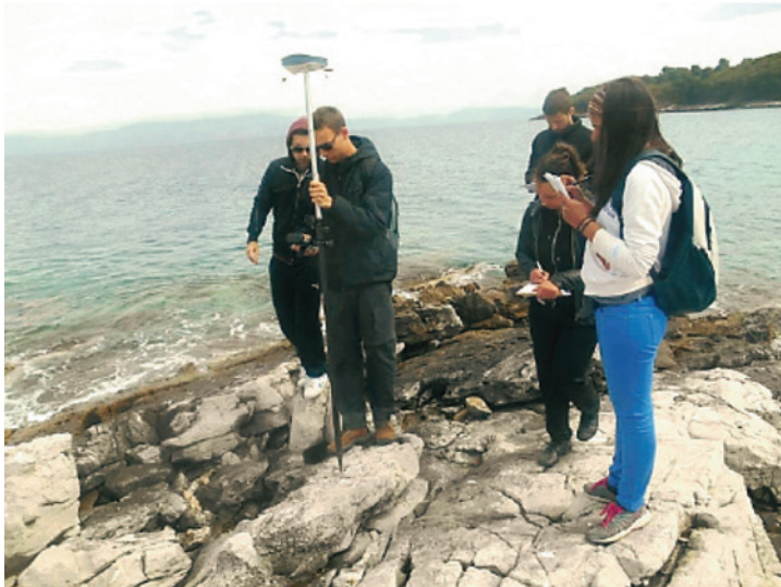
Prikupljanje podataka na otoku Galiciji s pomoću RTK-GPS Astech ProMark 500
