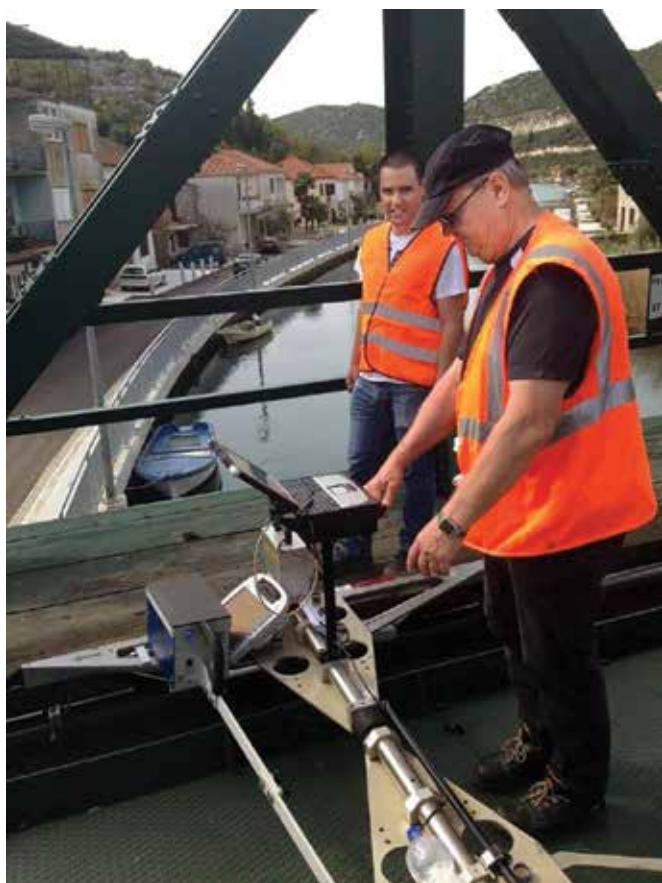
Slika 2: Vossloh je pružio potporu kod ručnog postupka mjerenja (izvor: Vossloh).
