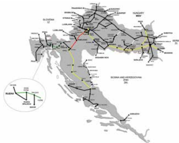
Slika 3: Karta prikazuje različite pružne dionice koje su prošle ispitivanje u sklopu sporazuma te koje su djelomično podvrgnute glodanju. Žutom bojom označene su dionice na kojima su izvedena četiri postupka ispitivanja tračnica, zelenom bojom označene su dionice na kojima je glodanje već izvedeno, crvenom bojom označene su dionice na kojima se planira glodanje, a bijelom bojom označene su pruge na kojima se trenutačno ne vozi (izvor: HŽ Infrastruktura).
