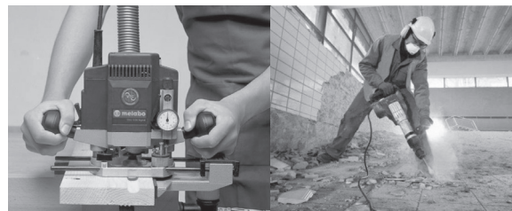
Slika 1. Strojevi i uređaji na mehanizirani pogon na kojima se ne mogu primijeniti osnovna pravila zaštite od mehaničkih opasnosti
