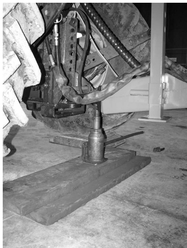
Slika 4. Podizanje ruda poluprikolice radi odvage samo traktora
