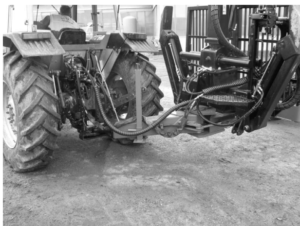
Slika 10. Zakretanje ruda pomoću horizontalnoga zgloba Fig. 10 Shaft shift with horizontal wrist
