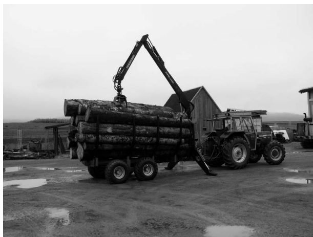
Slika 1. Šumska traktorska poluprikolica »Lika« s hidrauličnom dizalicom »Palms« prikopčana na poljoprivredni traktor Massey-Ferguson 365
