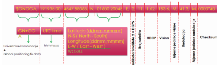
Slika 3. 3. Primjer strukture $GNGGA rečenice
