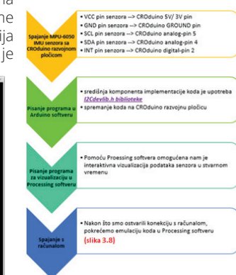
Slika 3. 9. Dijagram postupka implementacije Invesense MPU-6050 s računalom
