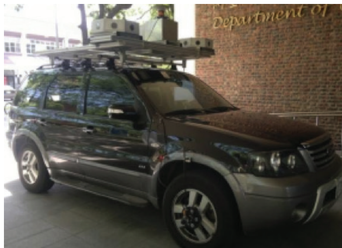
Slika 2. Integracija različitih senzora za autonomnu navigaciju vozila (Chiang i dr., 2013)
