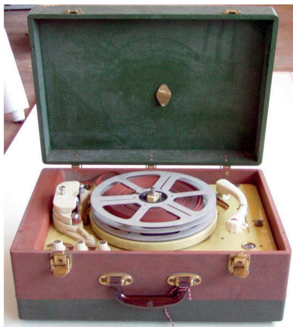
Slika 12. Kombinirani audio uređaj gramofon-magnetofon - TMinv. br. 4234; Fototeka TM-a; snimio: Zvonimir Ambruš
