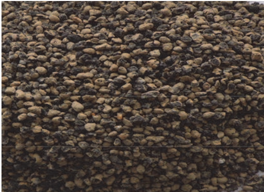
Slika 2. Agregat od ekspandirane gline (LECA)
