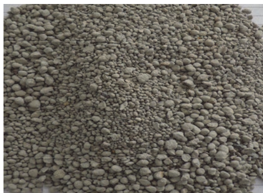
Slika 1. Agregat od letećeg pepela (FAA)
