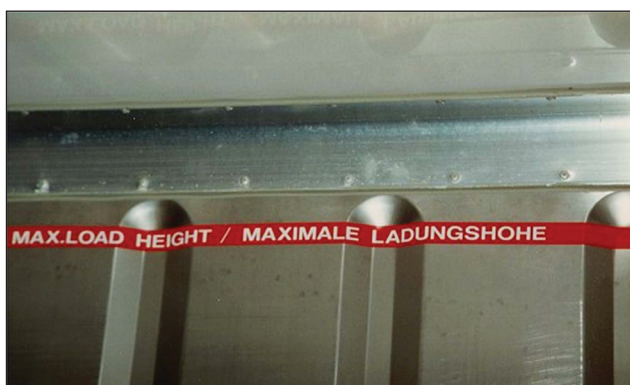
Figure 3 Maximum load height in refrigerated container [6] Slika 3. Maksimalna visina opterećenja u rashladnom kontejneru [6]
