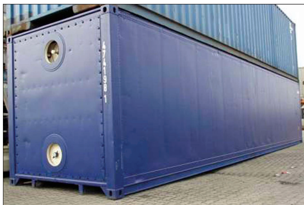
Figure 4 Porthole container [8] Slika 4. Izolacijski kontejner [8]
