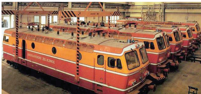
Tiristorske električne lokomotive od 4400 kilovata, brzine do 160 km/h (FOTO: croatianhistory.net)
