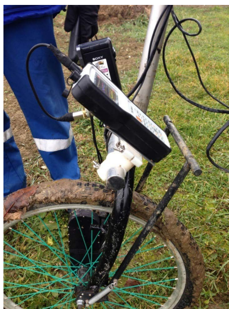
Slika 8c Nosač instrumenta i video kamere zajedno s enkoderskim odometrom (izvor slike: HRID - Non destructive testing)
