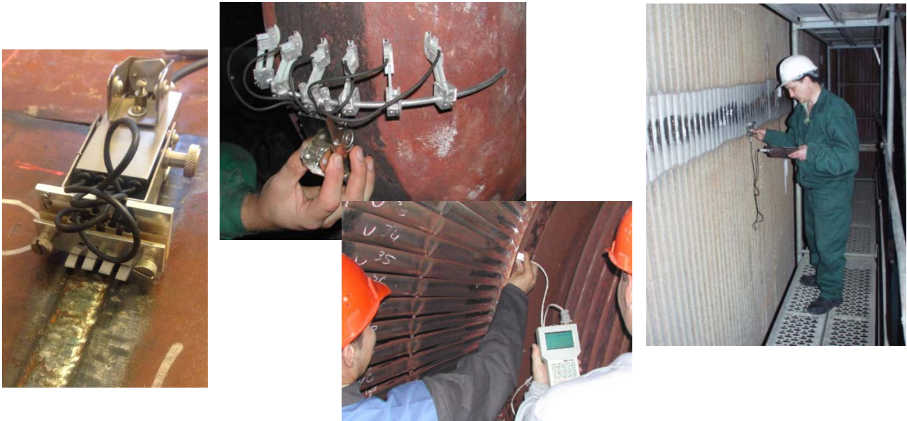
Slika 4 Prikaz MMM ispitivanja - skeniranje se provodi sa senzorima u kontaktu sa objektom koji ne zahtjeva specijalnu površinsku primjenu (razmak samog senzora i površine objekta je cca 1 mm). Prikazani primjeri su ispitivanje zavora, cjevovoda, lopatica turbine, te cijevi kotla termoelektrane. Za svaki ispitni objekt postoje namjenski držači senzora radi ubrzanja ispitivanja kao i univerzalni držači senzora. (izvor slike: HRID – Non destructive testing i Energodiagnostika)
