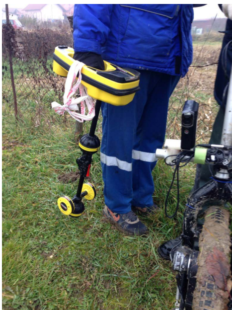
Slika 7 Tipičan lokator cjevovoda - na slici proizvođača RIGID (izvor slike: HRID - Non destructive testing)
