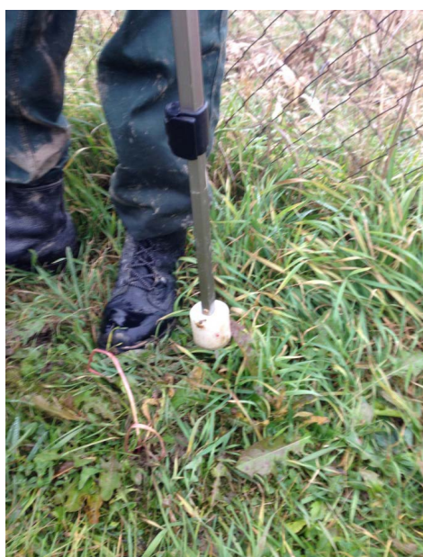
Slika 8a 3-osni senzor blizu površine za prikupljanje NCMD podataka (izvor slike: HRID - Non destructive testing)
