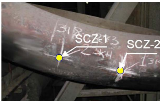
Slika 2 Primjer komponenti prirodnog magnetnog polja zavarenog spoja i shematski prikaz sonde za MMM ispitivanje zavarenog spoja – senzori ispituju zonu utjecaja topline kao i sam zavar (izvor slike: Energodiagnostika)
