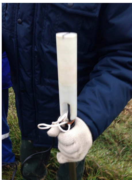
Slika 8b 3-osni senzor udaljen od površine. Osim senzora u kućištu je i elektronika za oba senzora (izvor slike: HRID - Non destructive testing)
