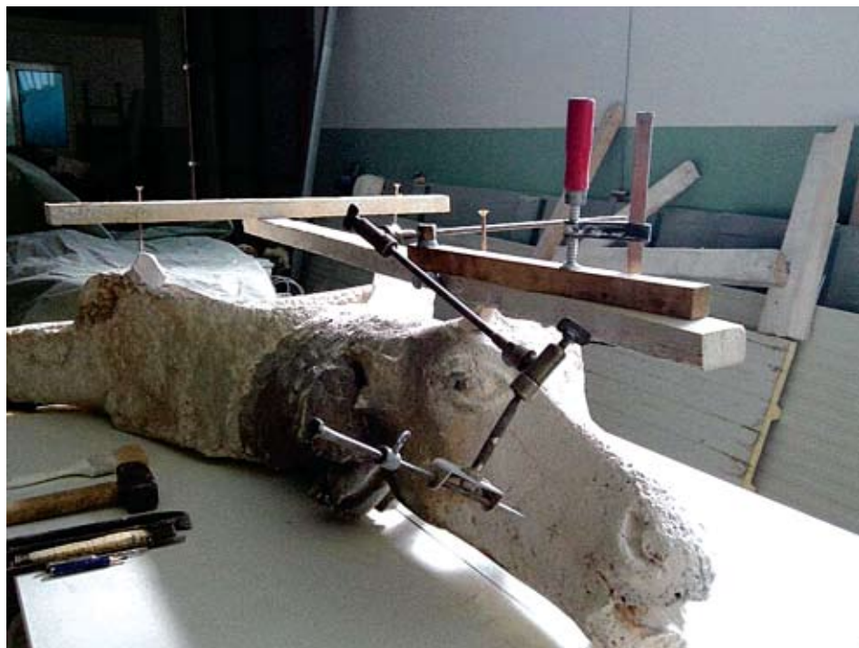
Proces prenošenja točaka originala pomoću punktirke
