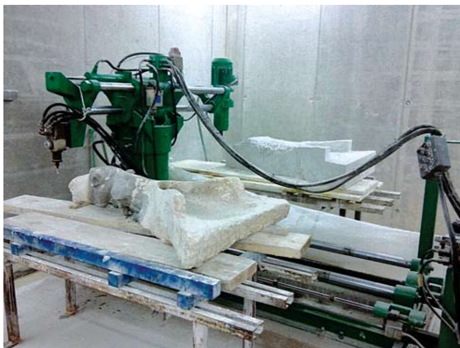
Prva faza izrade kamene replike na kopirci CNC
