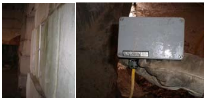
Slika 6.: Merilec pomikov EL BEAM z 2 m kovinsko palico in merilec pomikov EL TILT SENZOR
