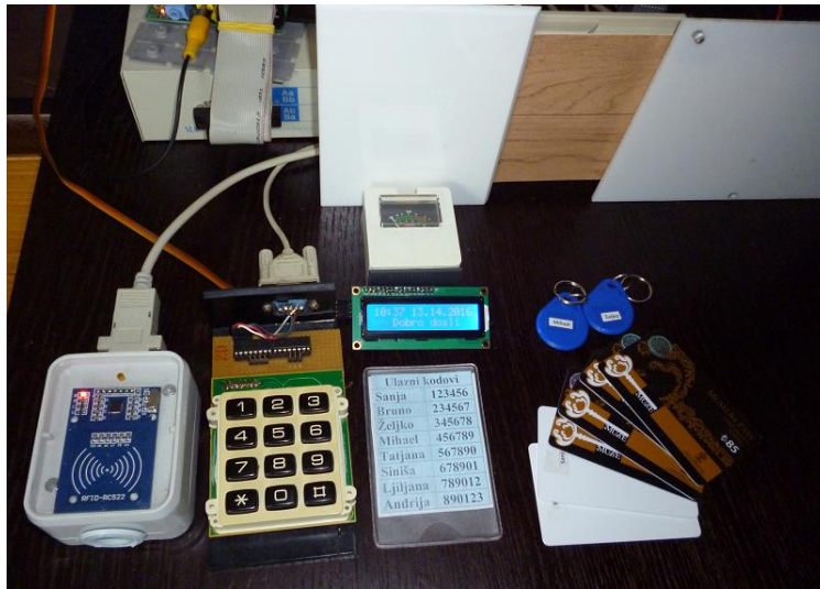
Slika 5. Maketa elektromotorom pokretanih vrata, RFID čitač, Tipkovnica, mjerač jakosti EM polja LCD displej i RFID tagovi (kartice i oznake)
