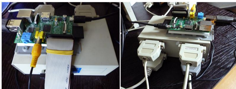
Slika 4. Raspberry Pi i razvodna kutija GPIO konektora
