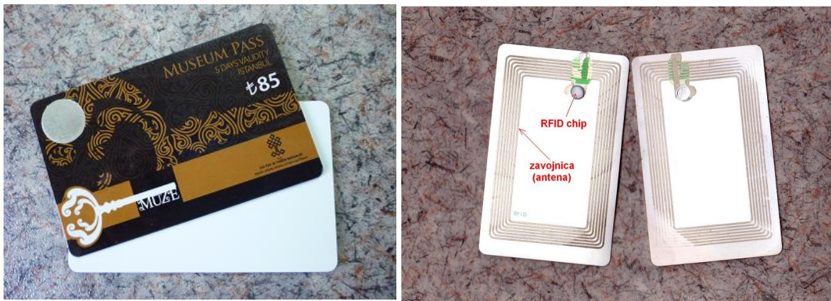
Slika 1. Izgled RFID kartica (lijevo), unutrašnjost RFID kartice (desno)
