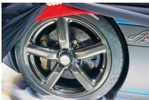
SLIKA 22 – Naplatak izrađen od epoksidne smole ojačane ugljikovim vlaknima 44
