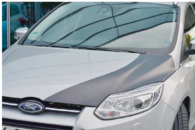
SLIKA 15 – Fordov poklopac motora ojačan ugljikovim vlaknima 28
