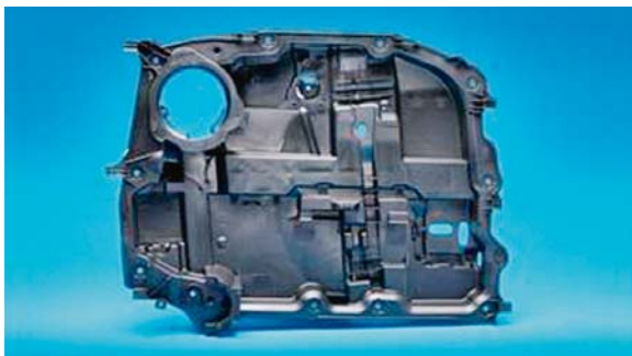
SLIKA 17 – Modul vrata za automobil Chrysler Jeep Liberty 32
