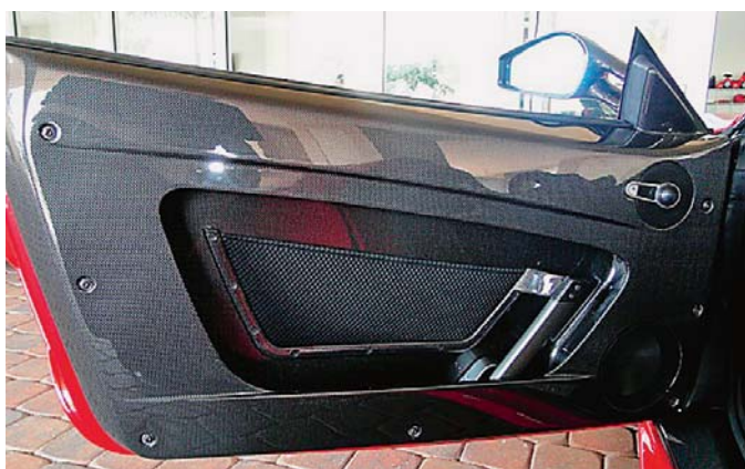
SLIKA 18 – Paneli vrata načinjeni od plastomerne matrice ojačane ugljikovim vlaknima 33
