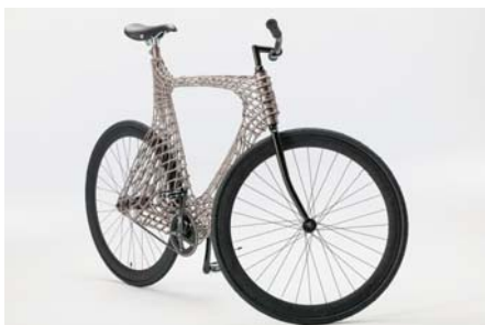
SLIKA 30 – 3D tiskani bicikl od nehrđajućeg čelika
