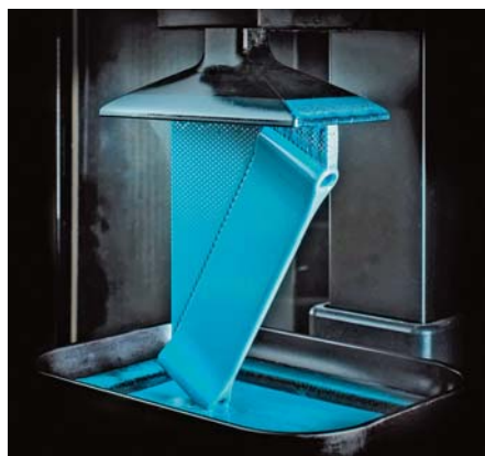
SLIKA 21 – Savitljiva poliuretanska tvorevina debljine 5 mm koja može izdržati udarac a da se ne deformira ili slomi
