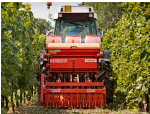
Slika 3.: Sjetva ozelenjenih staza specijalnom sijačicom pogodnom za uske radne zahvate u voćnjacima i vinogradima.
