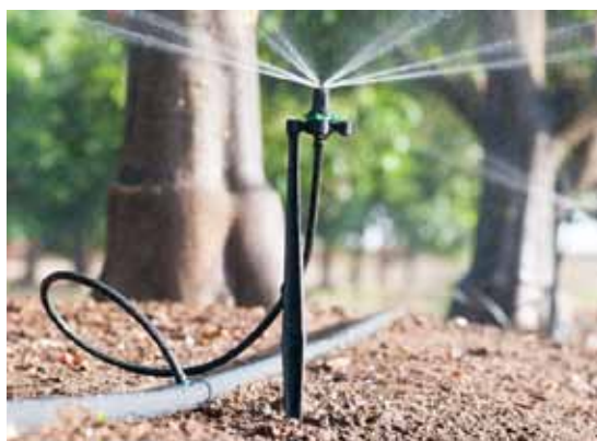
Slika 2. Minirasprskivač u radu
