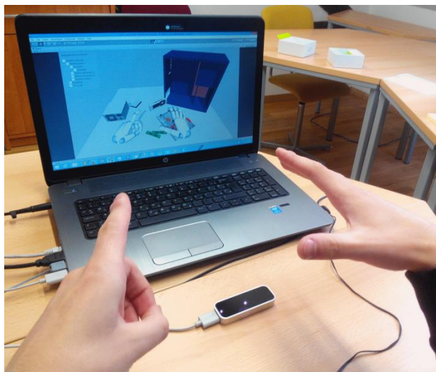
Slika 2. Korištenje „Leap Motion“ uređaja unutar platforme za razvoj igara „Unity“
