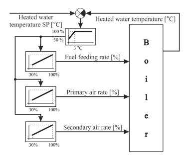
**Figure 1**. Scheme of a common method of small-scale **Slika 1.** Shema uobičajene metode kontrole umanjenjih kotla na biomasu.
