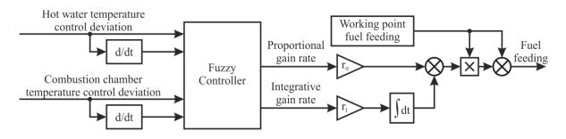
**Figure 3.** Block scheme of control algorithm using fuzzy controller **Slika 3.** Blok shema regulacijskog algoritma korištenjem neizrazitog regulatora
