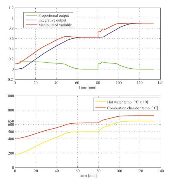
**Figure 4.** Simulation of set-point tracking control **Slika 4.** Simulacija praćenja potrebnih vrijednosti regulacijskog procesa.
