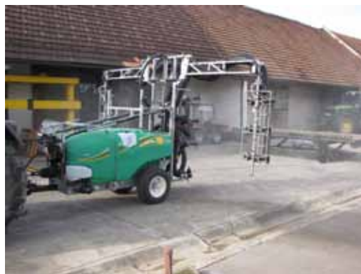
Slika 2. Orošivač B s radijalnim ventilatorom
