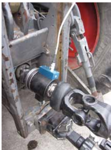
Slika 3. Dinamometar (Lorenz Messtechnik DR 2472 5000 Nm) za mjerenje momenta i broja okretaja.
