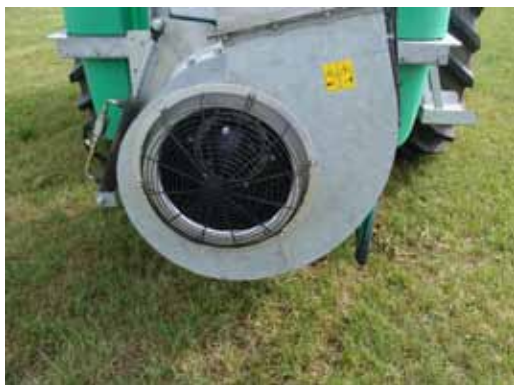
Slika 1. Radijalni ventilator kod orošivača A
