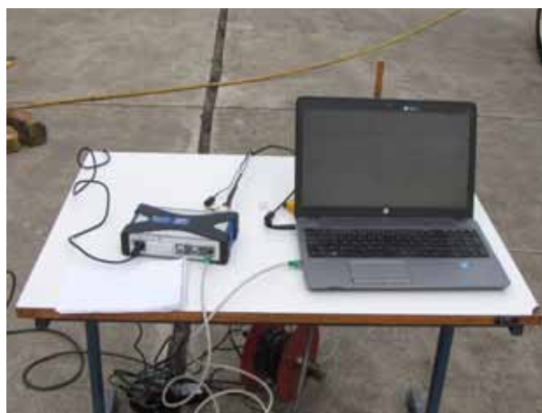
Slika 4. Digitalno mjerno pojačalo (Quantum Hottinger Baldwin Messtechnik)
